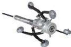
El Tipo "B" Skid ajustable, para la D46/SL, se utiliza para el diámetro mayor tuberías en líneas de 8 a 15 pulgadas de diámetro. El tipo de Skid "B" es de aluminio con tornillería de acero inoxidable y ruedas de poliuretano.
